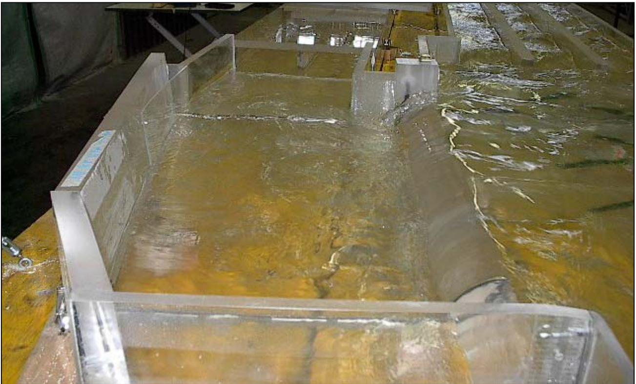
*Foto 5 – Sfiatore laterale di alimentazione al bypass secondo progetto Ferrovie.*
