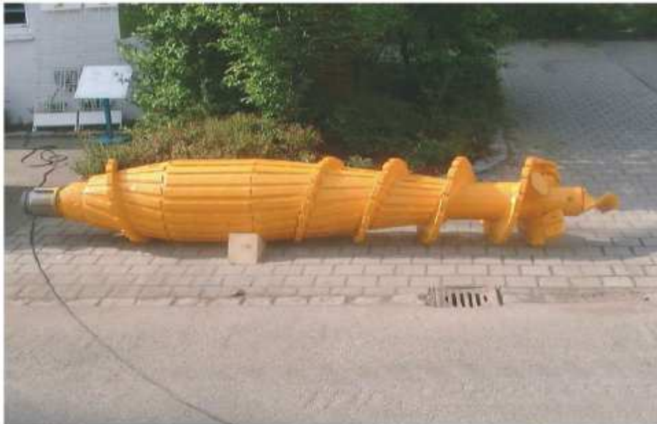
Figura 81: Corpo dislocante del sistema FDP
