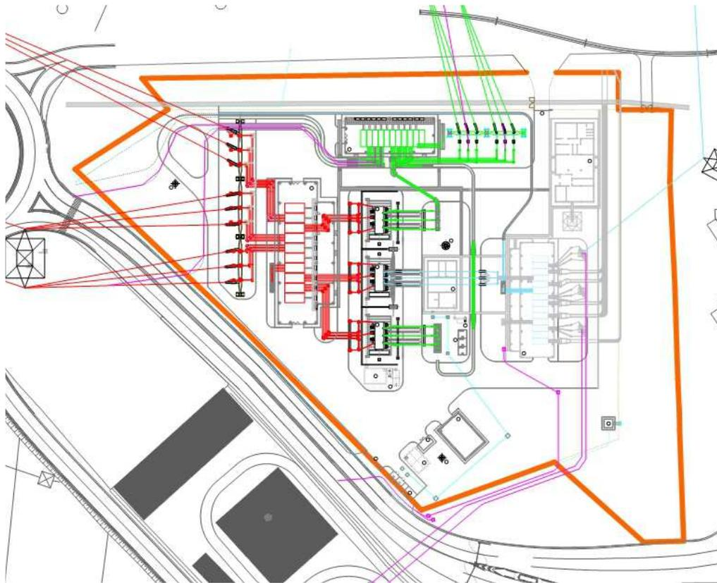
**Figura 10 – Planimetria S.E. Fusina II. In rosso i collegamenti 380 kV, in verde i 220 kV e in azzurro i 132 kV**
