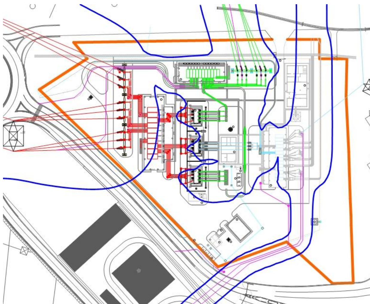
Figura 3 – Curve isolivello del campo magnetico sul piano orizzontale a 2 m da terra a 3 µT (in blu), nell'area di calcolo considerata.
