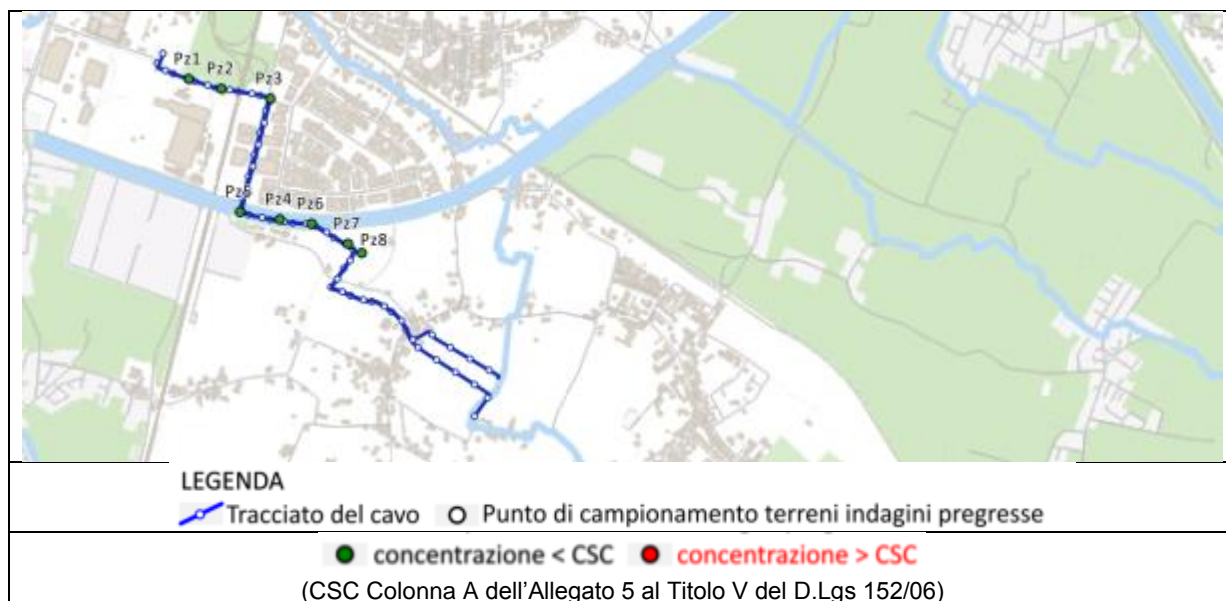
Figura 5.1-2: Ubicazione delle indagini pregresse lungo il tracciato degli interventi A2/4 e A2/5
