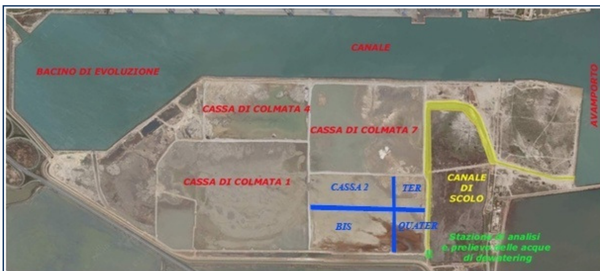
Figura 4-6 Vasche di colmata nell'avamposto ovest del Porto Canale.
