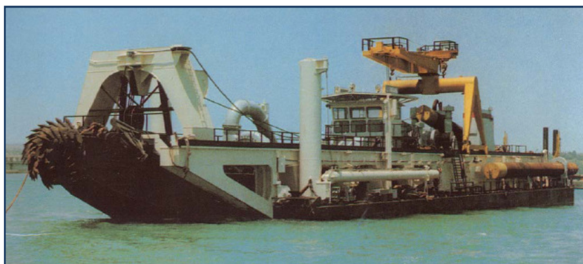
Figura 5-3 Draga aspirante refluyente con disgregatore.
