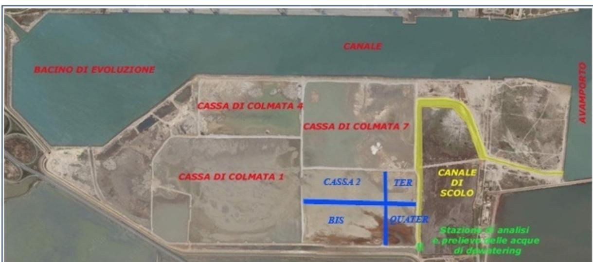
Figura 4-2 Vasche di colmata nell'avamposto ovest del Porto Canale.
