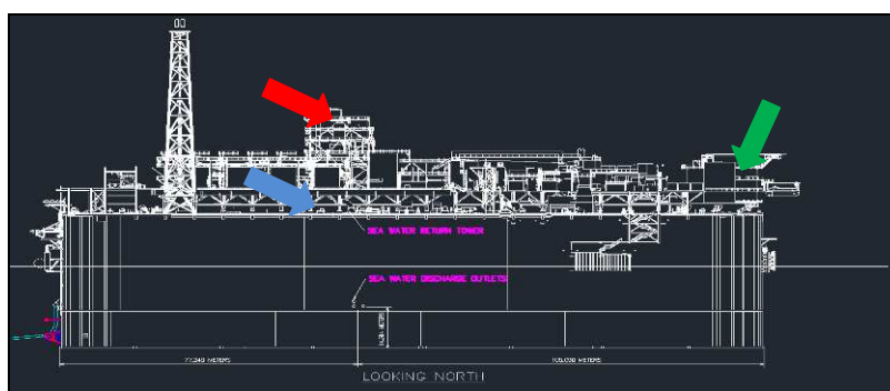
Figura 4 Ubicazione dei punti di osservazione, le frecce indicano: in blu il Livello 1, in rosso il Top recondenser ed il verde il tetto del modulo alloggi.
