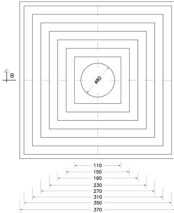
PIANTA ARMATURA PLINTO DI FONDAZIONE
