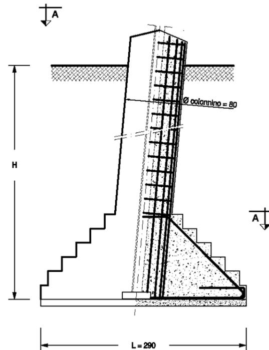
PIANTA - SEZIONE A-A PLINTO FONDAZIONE
