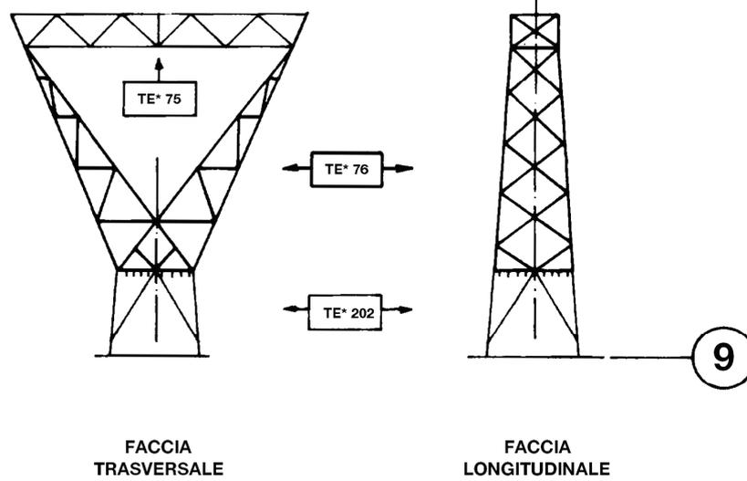
**SCHEMA SOSTEGNI E\* CON ALTEZZE DISPARI**
