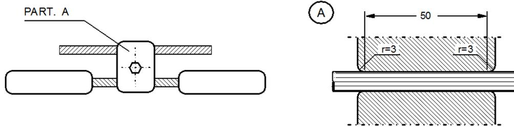
Morsetto ad un solo bullone del tipo "a montaggio facilitato". La lunghezza minima del tratto di conduttore serrato è indicato nel particolare A.
