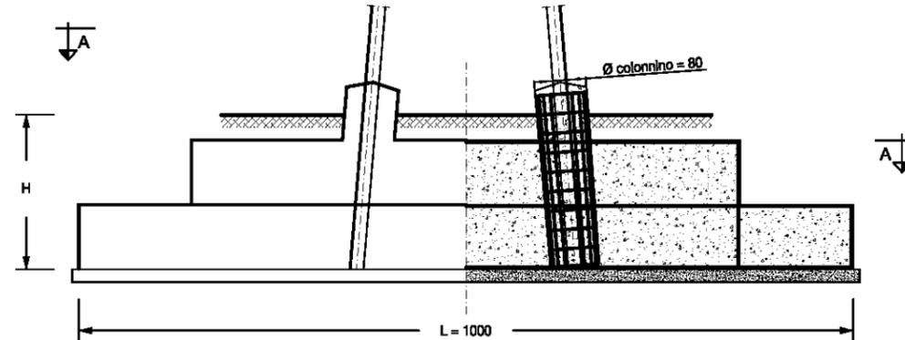
**PIANTA - SEZIONE A-A PLINTO FONDAZIONE**
