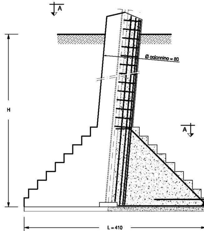
**PIANTA - SEZIONE A-A PLINTO FONDAZIONE**
