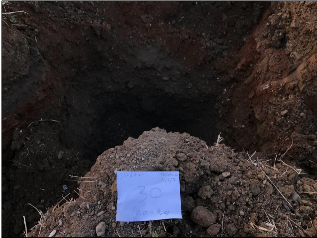
Sc30 – Scavo geognostico (0,0-4,0m da p.c.)
