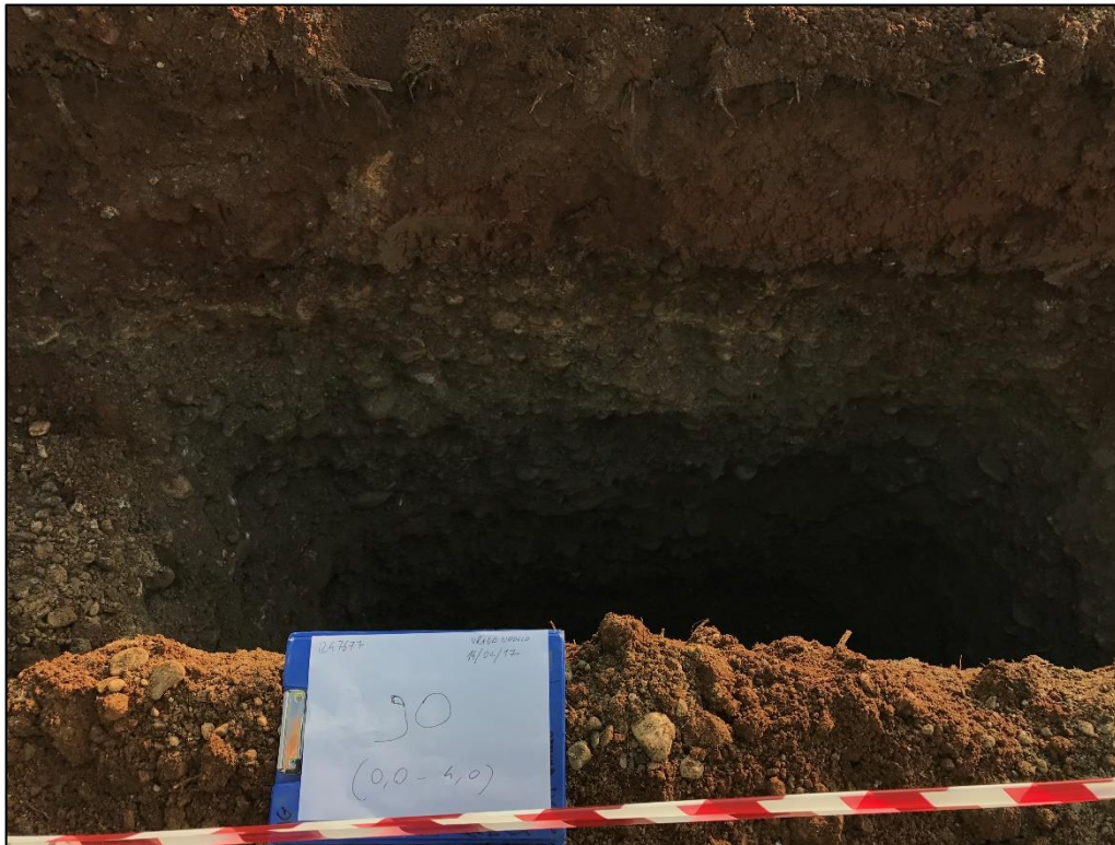
Sc90 – Scavo geognostico (0,0-4,0m da p.c.)
