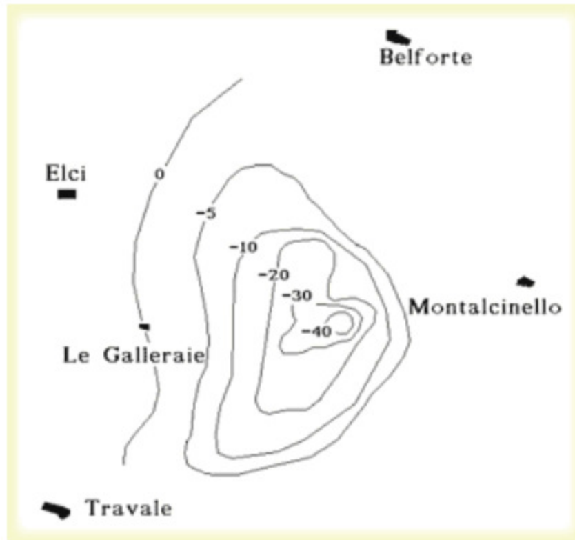
Figura 7-1. Subsidenza nel campo di vapore di Travale-Radicondoli per il periodo 1973-1991 (Di Filippo et al., 1995).
