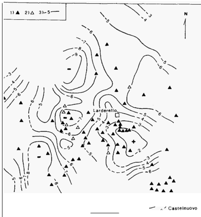
Figura 7-4. Variazioni di quota durante il periodo di rilevamento 1986-1993. 1) pozzi di produzione; 2) pozzi di reiniezione; 3) linee di variazione di quota (Dini et al., 1995).
