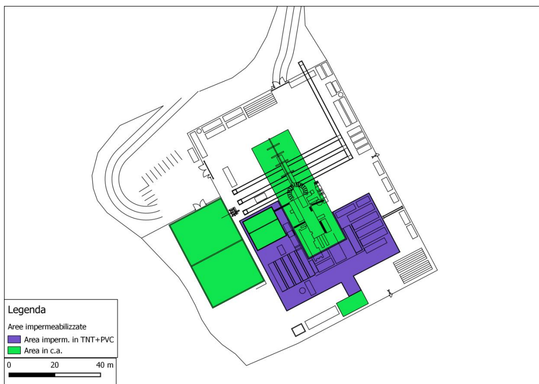
Figura 3-5. Individuazione delle aree impermeabilizzate e in cemento armato all'interno della postazione di perforazione Cortolla 1.
