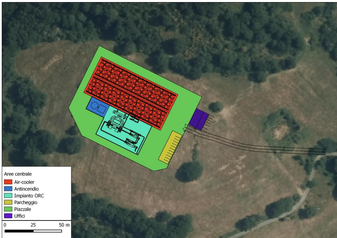
Figura 2-6. Aree della centrale geotermoelettrica.
