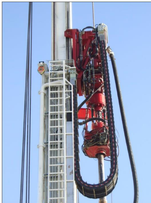
Figura 3-15. Top Drive su mast telescopico.
