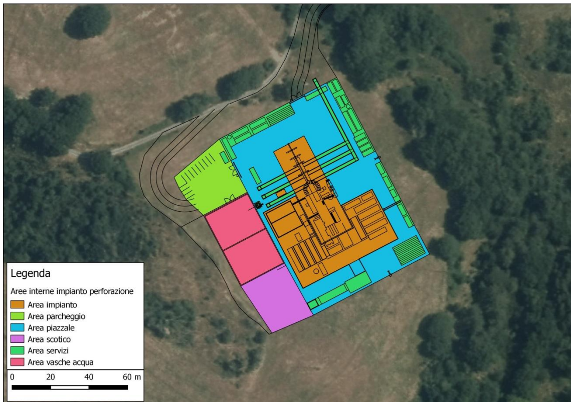
Figura 3-19. Organizzazione della postazione di perforazione Cortolla 1.
