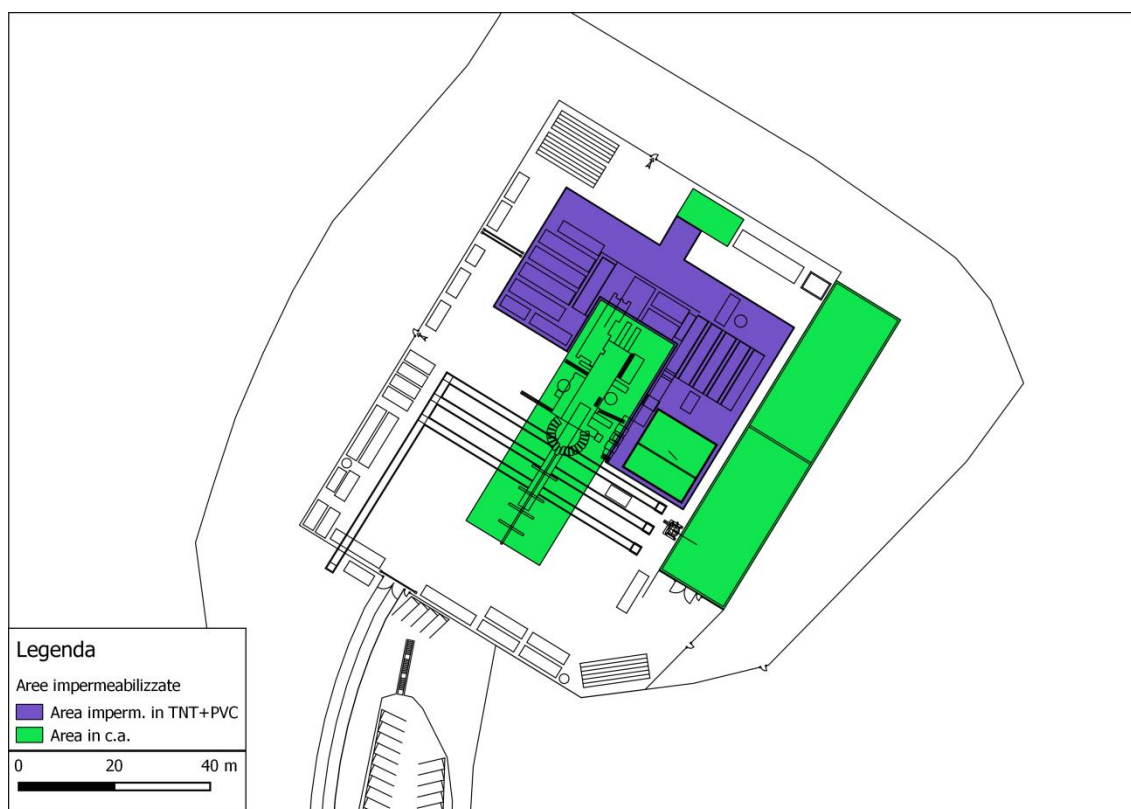
Figura 3-8. Individuazione delle aree impermeabilizzate e in cemento armato all'interno della postazione di perforazione Cortolla 2.
