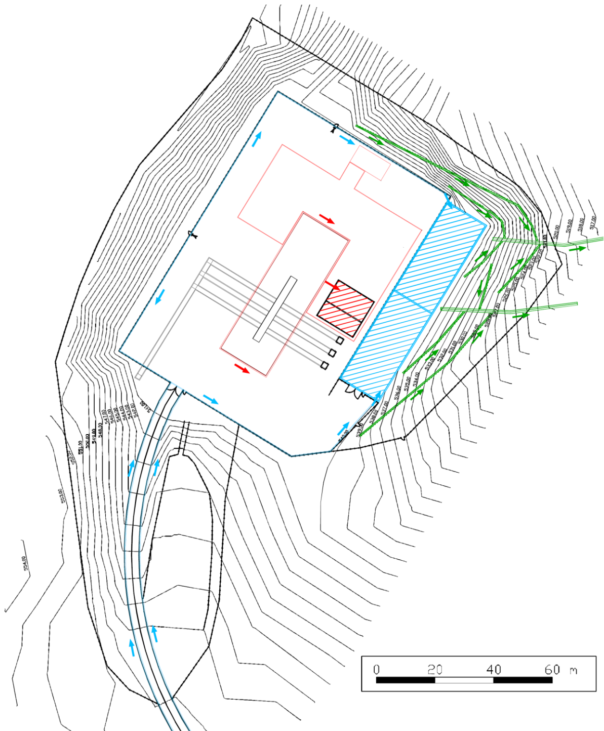
Figura 3-9: Schema della regimazione delle acque all'interno del Polo di Reiniezione.
