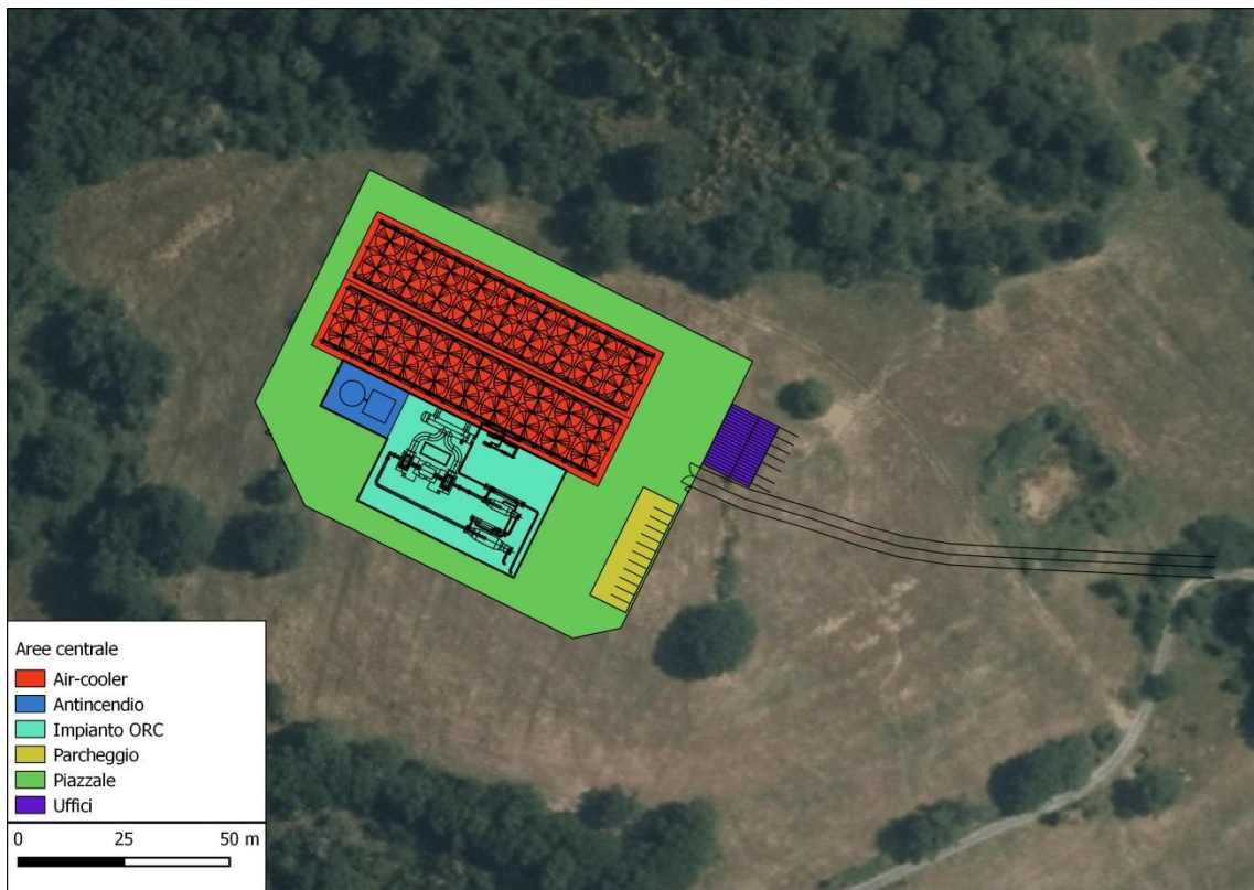
Figura 1-3. Layout centrale geotermoelettrica.
