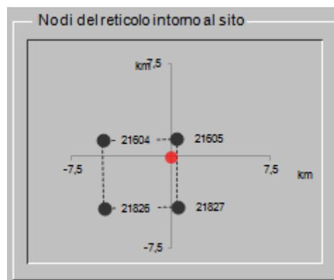
**Figura 11** – Ubicazione centro area polo di reiniezione rispetto ai nodi del reticolo di riferimento
