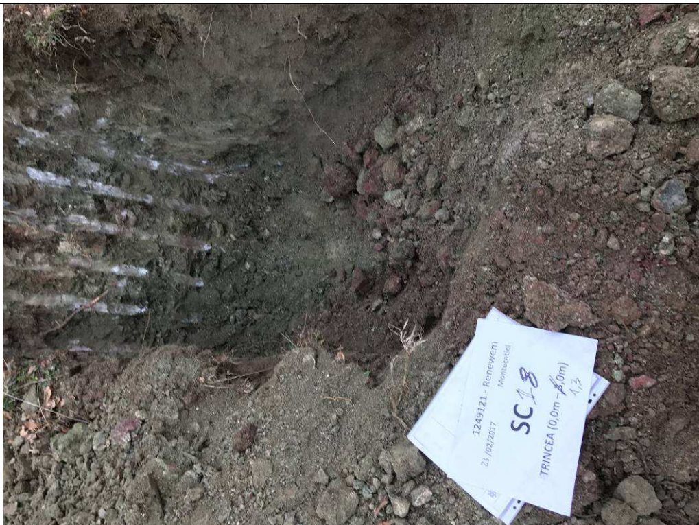
SC18 – Trincea (0,0-0,8) m p.c.
