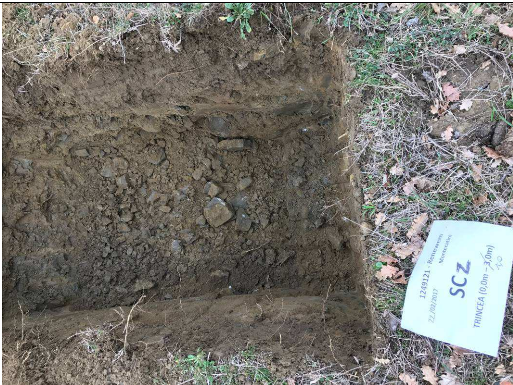
SC2 – Trincea (0,0-1,1) m p.c.
