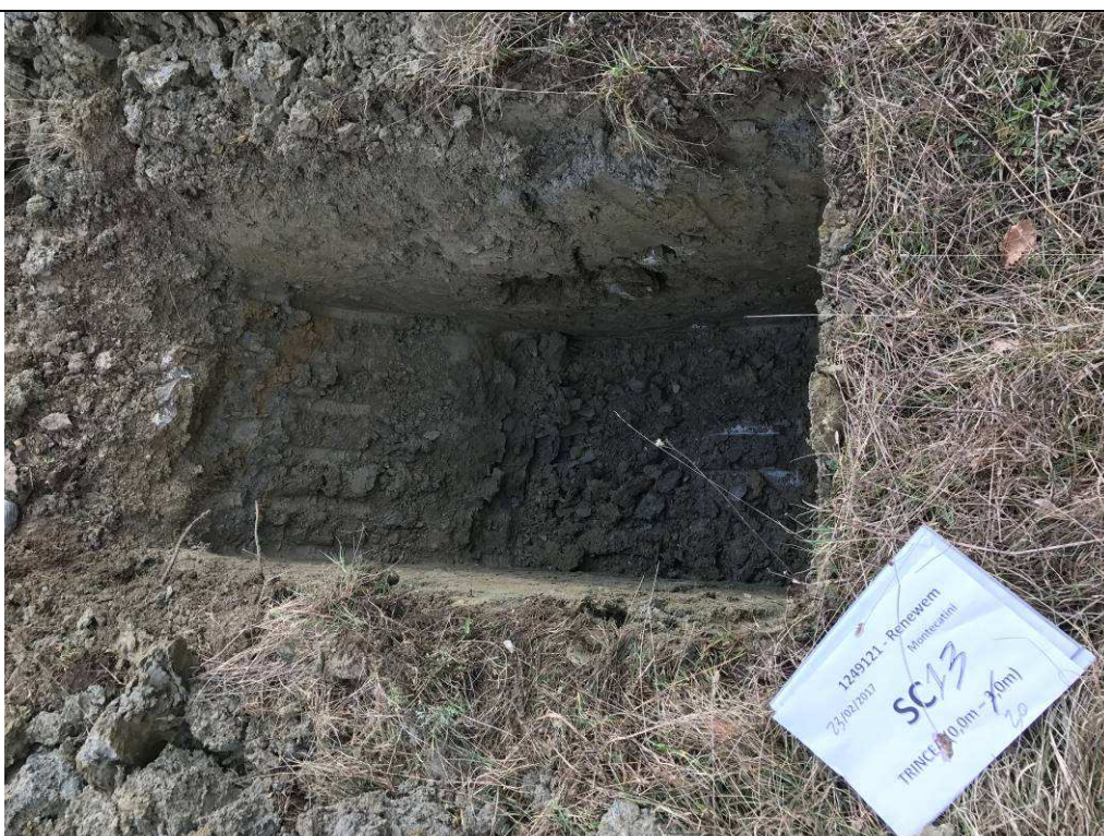
SC13 – Trincea (0,0-2,1) m p.c.
