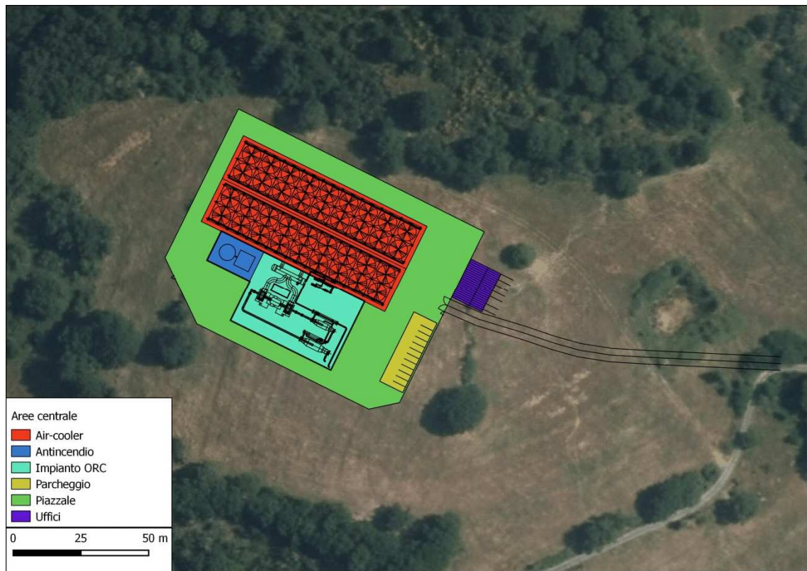
Figura 3-3. Layout centrale geotermoelettrica.
