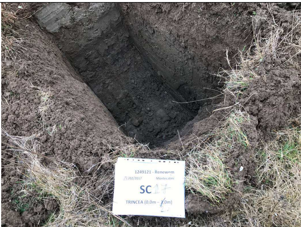
SC17 – Trincea (0,0-2,1) m p.c.
