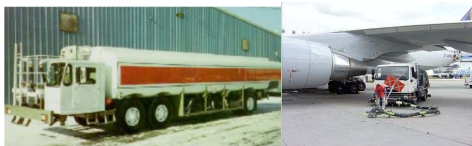
Figura D-1 Esempio di Fuel track per il rifornimento degli aeromobili
