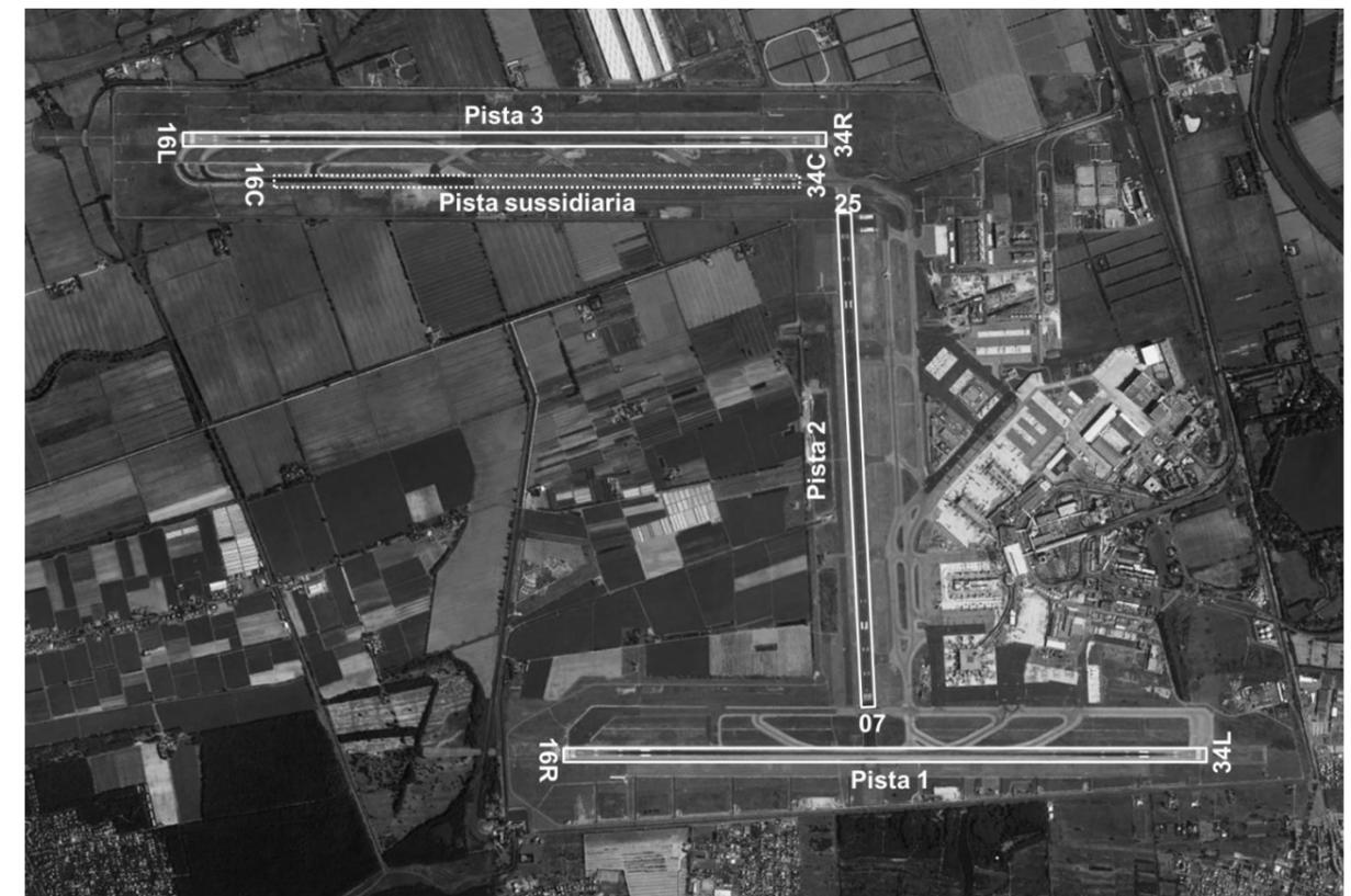
Figura 7-2 Identificazione delle piste di volo e delle relative testate pista
