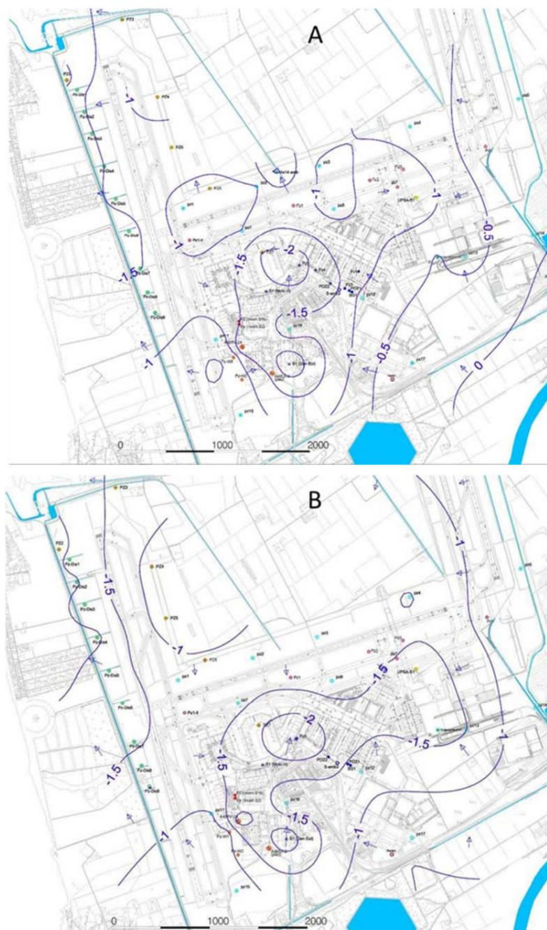
**Figura 4-1: Rete di monitoraggio piezometrico dell'area aeroportuale di Fiumicino. Restituzione dei dati piezometrici (in m s.l.m) relativi a mesi di Maggio 2015 (A) e Ottobre (B) 2015.**
