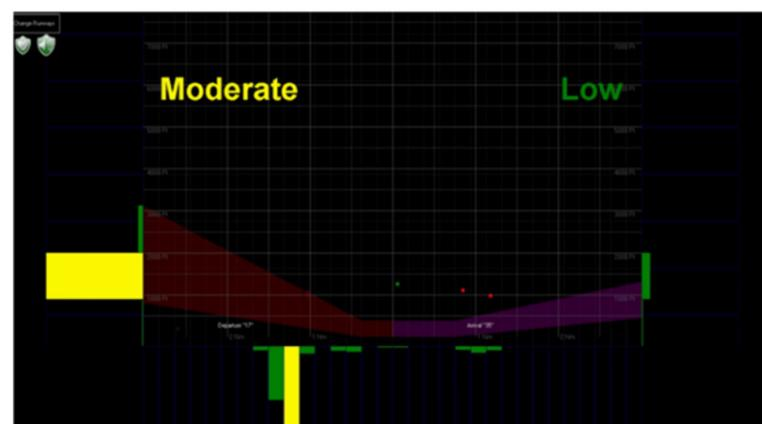
**Figura 5-13 Esempio di schermata del sistema MERLIN relativa al rischio di birdstrike verticale**
