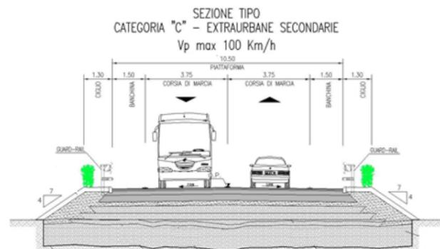
**Figura 0-28 Sezione tipo in rilevato viabilità di servizio**
