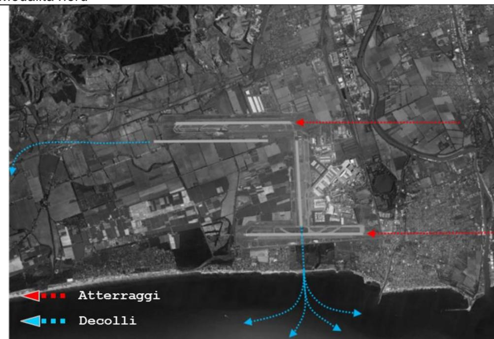
Figura 1-5 Scenario di Fase 1 del Masterplan: Rotte per tipologia di operazioni
