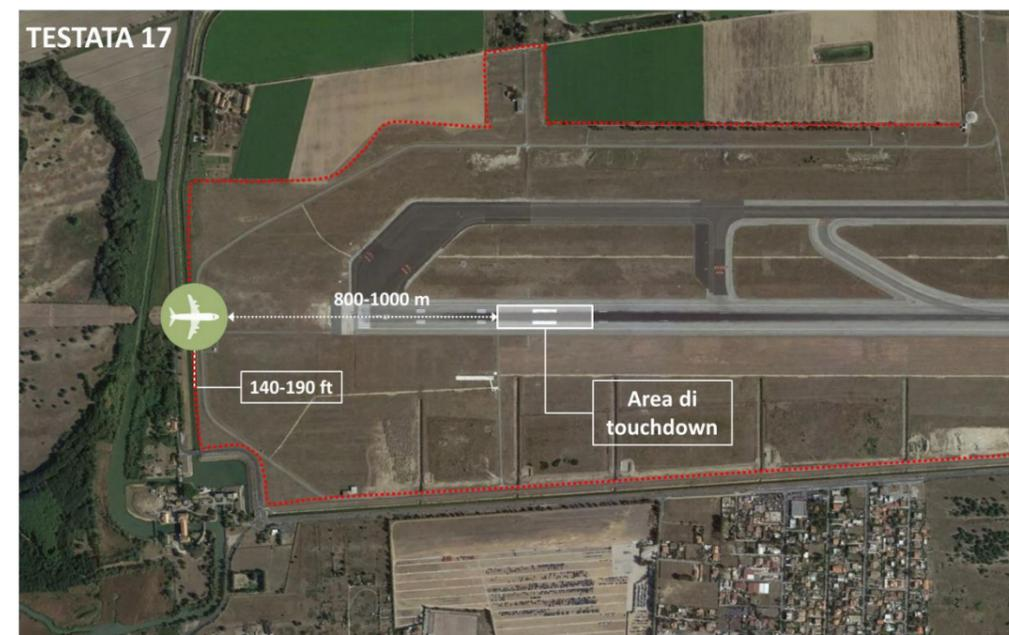
**Figura 3-4 Pista 1 Testata 17: il sedime aeroportuale si trova ad una distanza dal punto di contatto pari a 800 m (min) e 1000 m (max), con quota di sorvolo 140 ft (min)-190 ft (max)**
