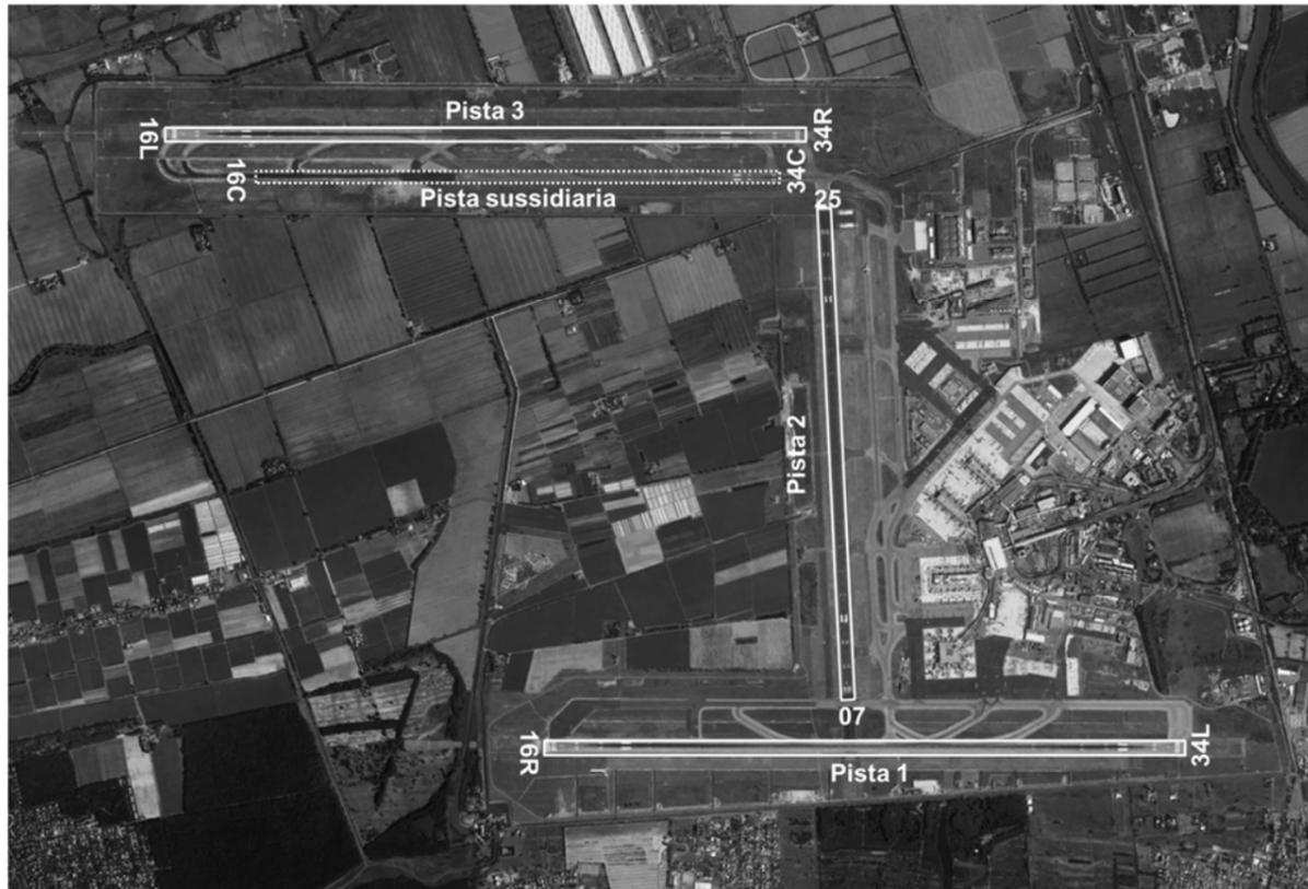
FIGURA 2.13 - IDENTIFICAZIONE DELLE PISTE DI VOLO E DELLE RELATIVE TESTATE PISTA
