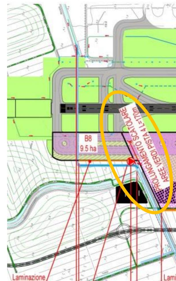
Figura 3-7 Prolungamento deviazione Canale Allacciante di Ponte Galeria
