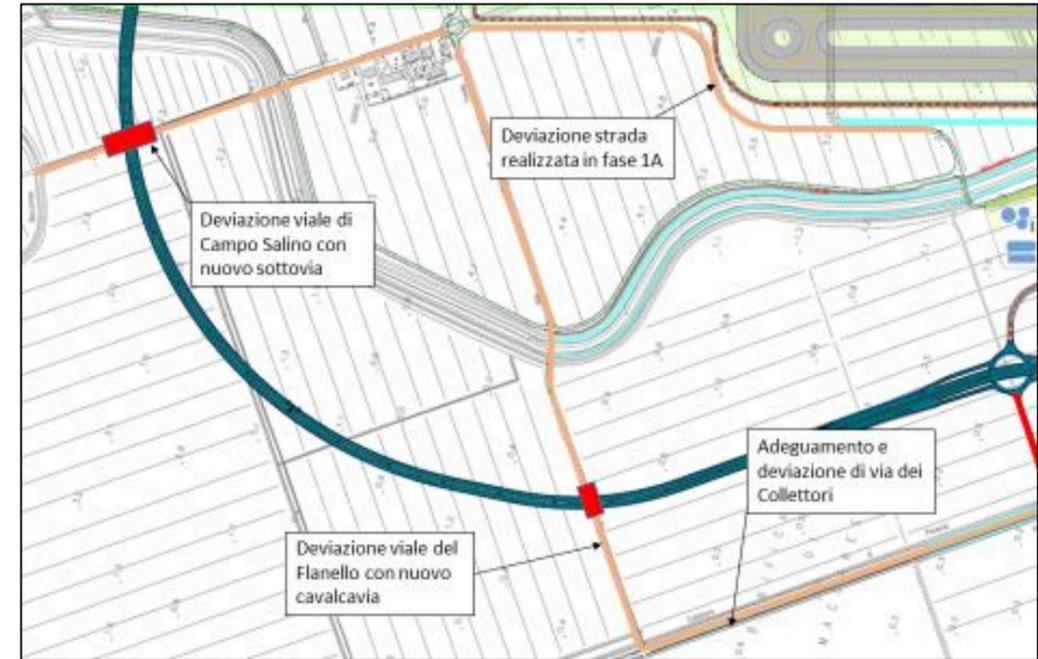
Figura 2-79 Deviazione viale di Campo Salino e viale del Flanello
