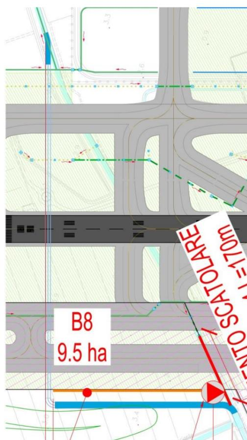
Figura 3-6 Canale di Recapito del Contributo delle aree pavimentate e Verdi della Pista 4
