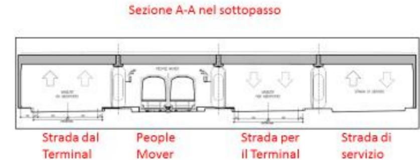
Nel sottopasso, la viabilità da FCO Nord occupa il primo fornice da Ovest, il people mover il secondo sempre da Ovest e la viabilità per FCO Nord il terzo. L'ultimo fornice è invece destinato al transito della strada di servizio.
