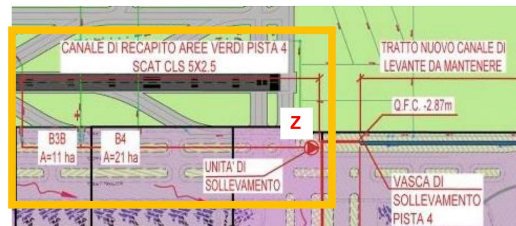
**Figura 3-5 Prolungamento Scarico Area Verde Pista4 "Scarico Intermedio 1"**
