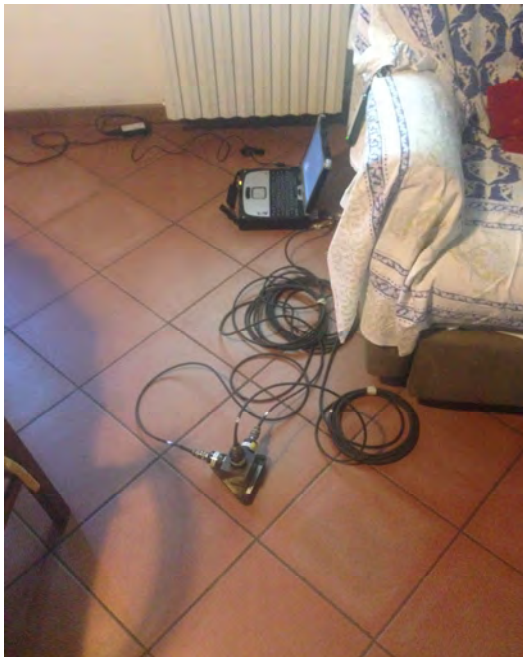
Posizionamento accelerometro triassiale, 1° piano f.t.
