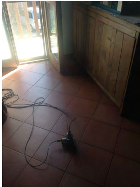
Posizionamento accelerometri monoassiali, 2° piano f.t.
