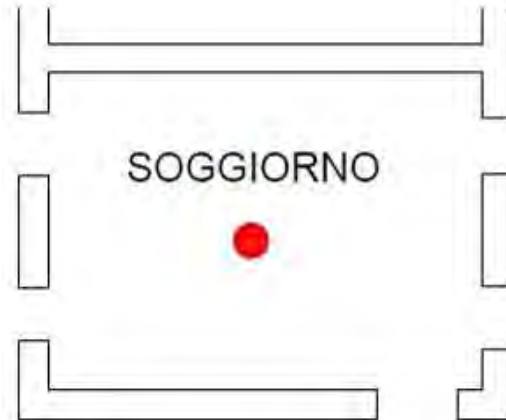
Posizionamento accelerometro triassiale, 1° piano f.t.
