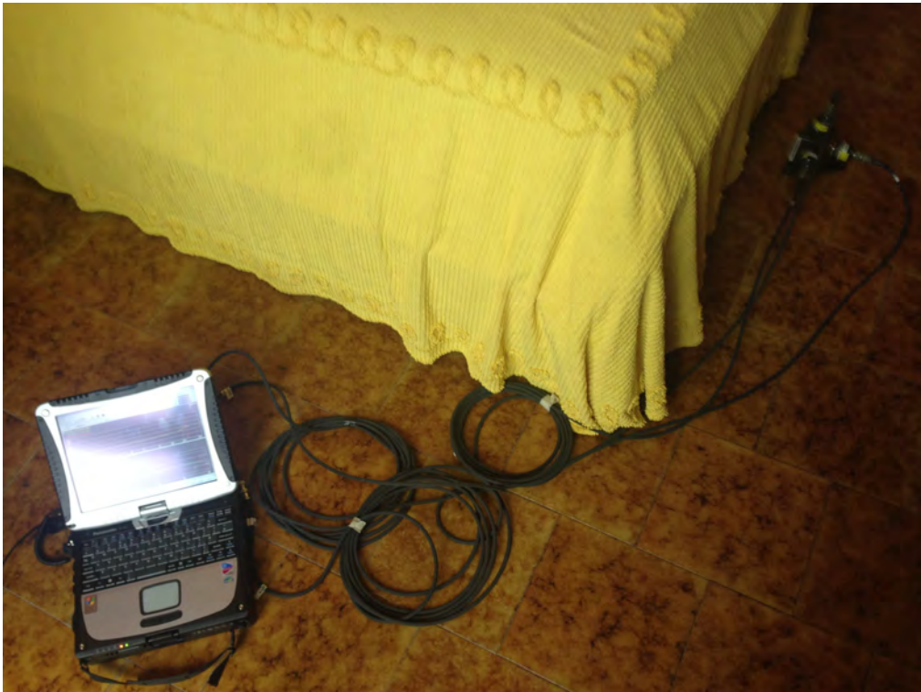
Posizionamento accelerometro triassiale, 2° piano f.t.
