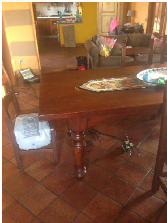
Posizionamento accelerometro triassiale, 2° piano f.t.
