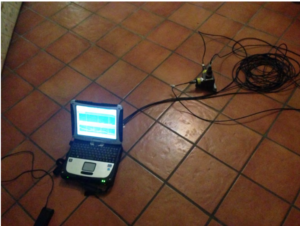
Posizionamento accelerometro triassiale, 1° piano f.t.
