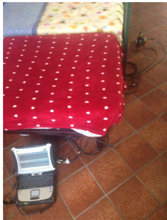
Posizionamento accelerometro triassiale, 3° piano f.t.
