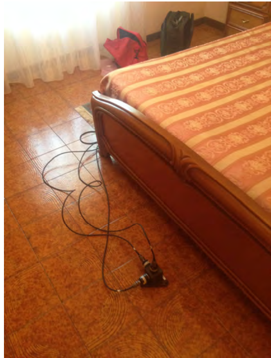
Posizionamento accelerometri monoassiali, 2° piano f.t.
