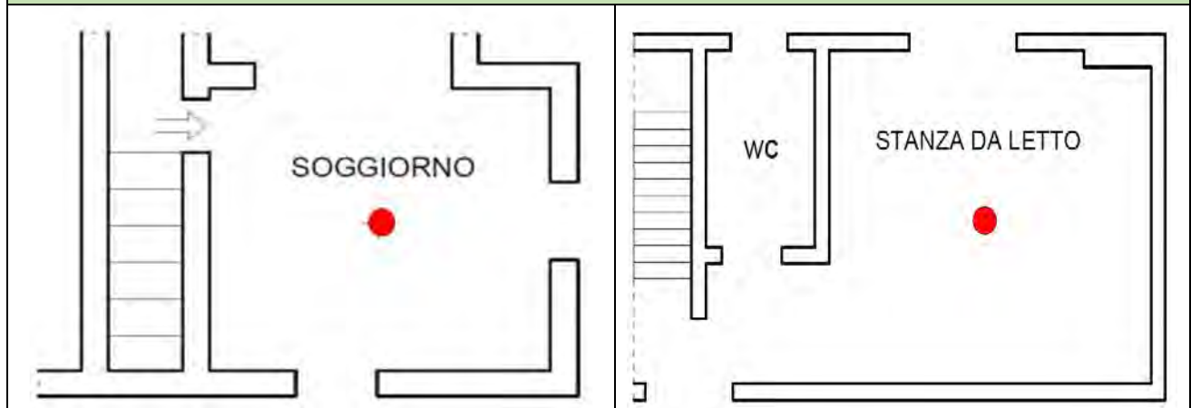
Posizionamento accelerometro triassiale, 2° piano f.t.
