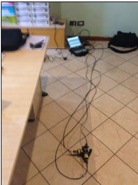
Posizionamento accelerometro triassiale, 1° piano f.t.
