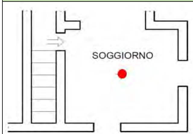
Posizionamento accelerometro triassiale, 2° piano f.t.
