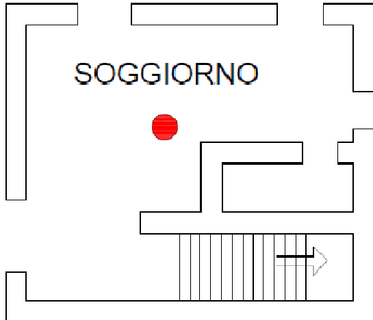
Posizionamento accelerometro triassiale, 1° piano f.t.
