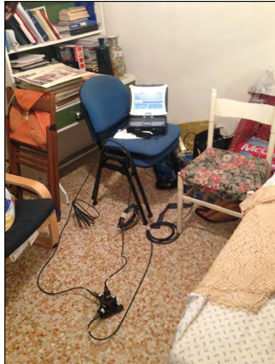
Posizionamento accelerometri monoassiali, 2° piano f.t.
