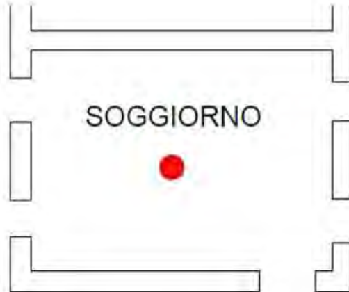
Posizionamento accelerometro triassiale, 1° piano f.t.
