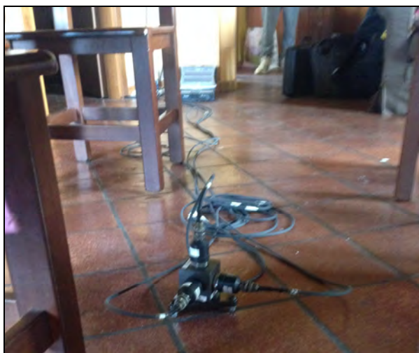
Posizionamento accelerometro triassiale, 2° piano f.t.
