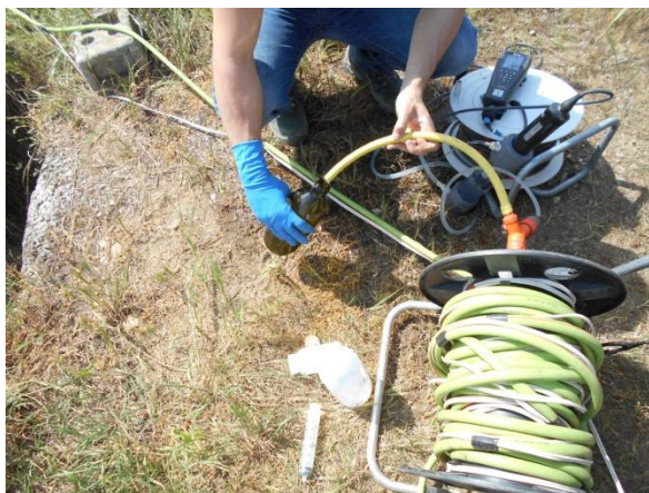
Punto AV-RO-SO-1-14 - Spurgo
