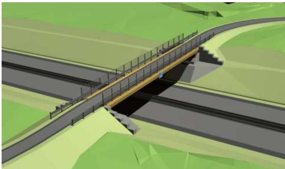
**Figura 29 – cavalcavia a spalle alte**
