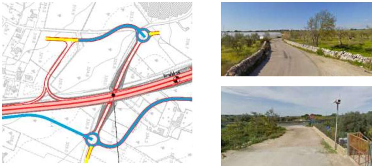
La tavola illustra anche una ottimizzazione planimetrica, apportata al km 16 c.ca del progetto preliminare (punto 2), volta a massimizzare il riutilizzo in sede della strada esistente ed a diminuire l'impatto sulle colture agricole e la creazione di aree intercluse; la modifica si pone pertanto in linea sia con la raccomandazione b) della Del. CIPE 51/2007, sia con le prescrizioni 28 e 64 della Del. CIPE 03/2010.
