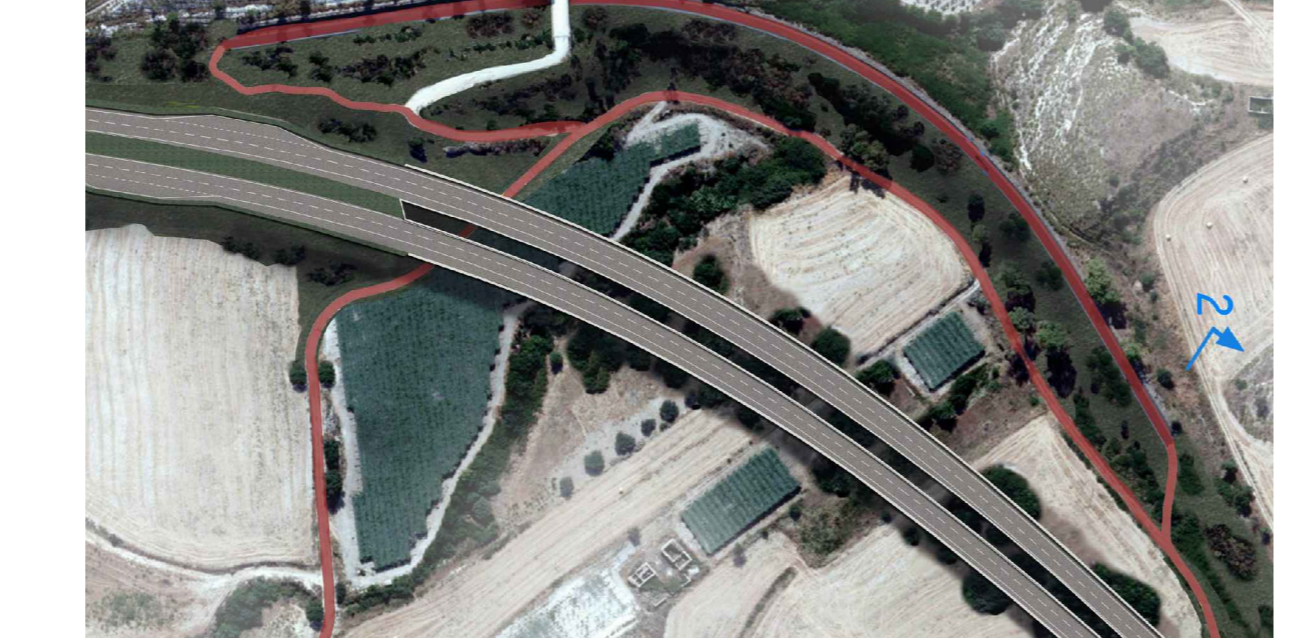
RIF 6: Esempio di sistemazione paesaggistica di rilevati alti con macchia arbustiva (Prescriz. 25)
