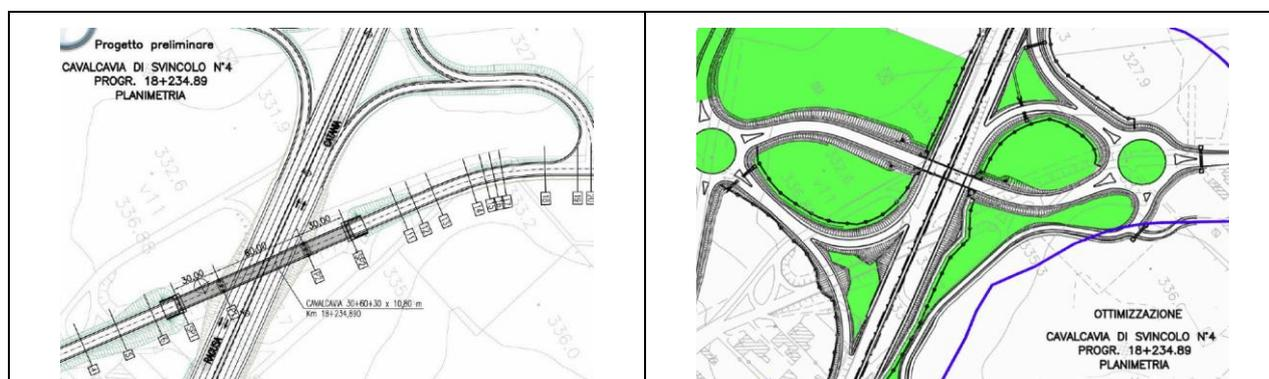
La configurazione più compatta dello svincolo consente una riduzione del consumo di suolo, in analogia con altre ottimizzazioni già apportate ad altre aree di svincolo nel rispetto della prescrizione n. 5 della Del. CIPE 79/2006. Le aree residue che si vengono a configurare sono oggetto di apposite sistemazioni paesaggistiche – ambientali, in linea con la prescrizione 28 della Del. CIPE 03/2010).
