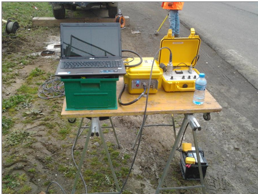
Figura 13 - Down-Hole: Sistema di acquisizione (sismografo collegato a laptop ).
