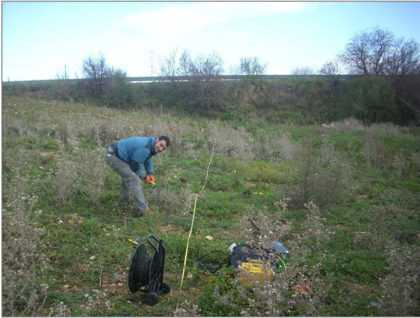
Figura 8 - MASW: Predisposizione stendimento M013.
