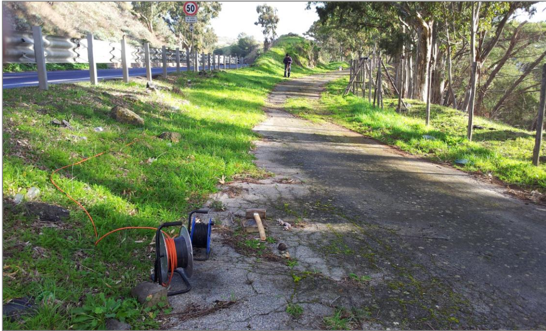
Figura 4 - Sismica a rifrazione: Predisposizione stendimento BS_148.
