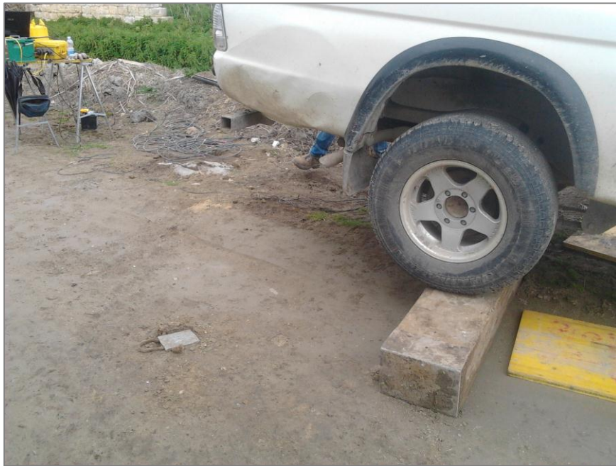
Figura 12- Down-Hole: Trave per energizzazione delle onde S.
