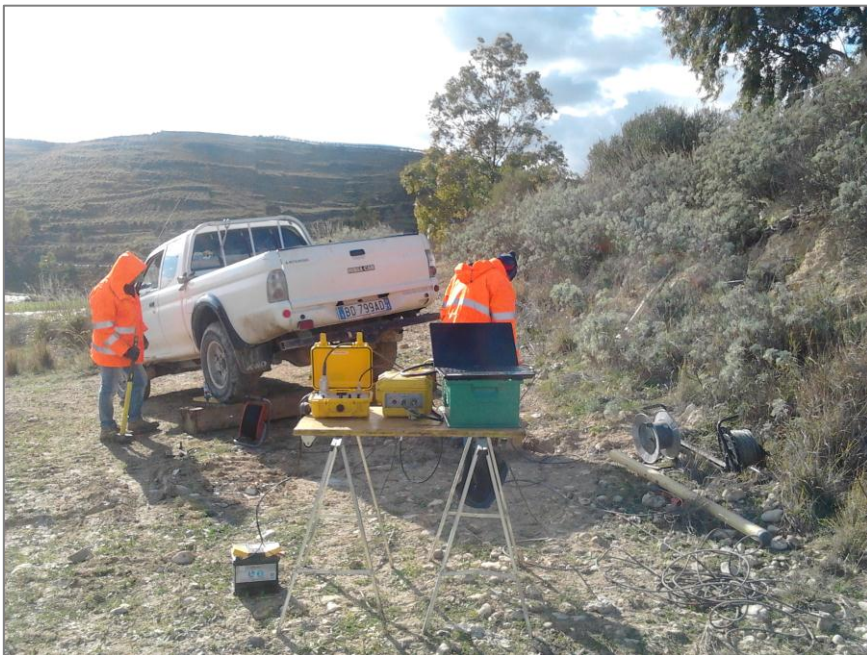
Figura 11- Down-Hole: Esecuzione di una prova.
