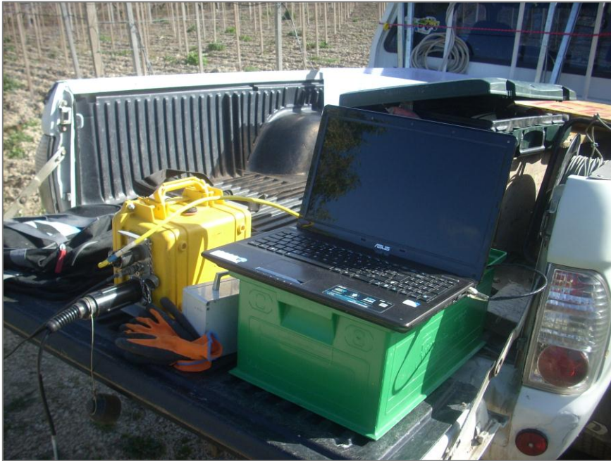
Figura 10 - MASW: Sistema di acquisizione (sismografo collegato a laptop ).
