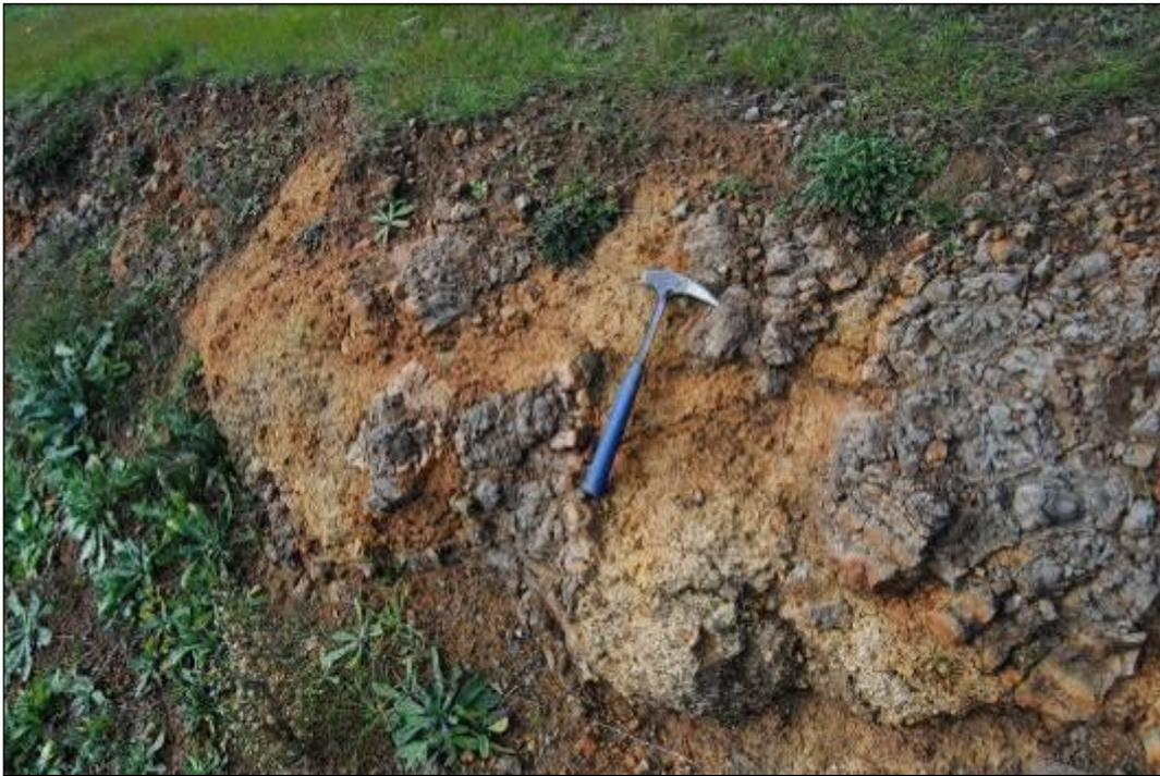
**Foto E.16 – Colate di lave bollose e scoriacee con subordinati prodotti piroclastici (Pvl) interessati dagli scavi della esistente trincea della S.S. 514, riprese in corrispondenza della pk. 4+500 del Lotto 6 di progetto.**
