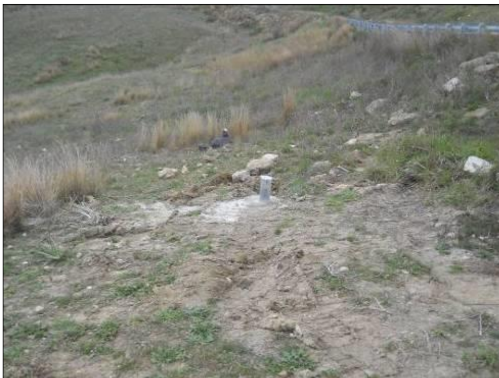
Foto F.4 – Chiusino posizionato in testa foro del sondaggio S105 bis equipaggiato con inclinometro.
