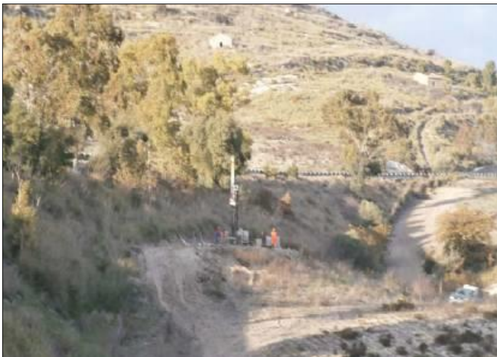
Foto C.2 – Esecuzione sondaggio S091 equipaggiato con inclinometro.
