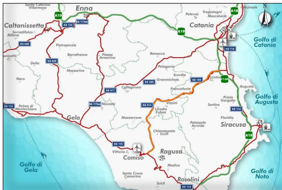
Il progetto prevede la riqualificazione dell'itinerario Ragusa-Catania attraverso la realizzazione di una strada a carreggiate separate con due corsie per senso di marcia e piattaforma pari a 22 m in accordo con la sezione tipo B del D.M. 5/11/2001: "Norme geometriche e funzionali per la costruzione delle strade".
