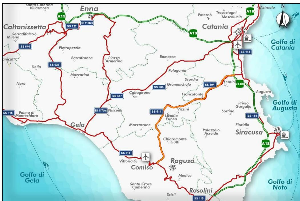
Il tracciato si snoda in larga parte sull'attuale sede delle SS524 e SS194, discostandosene solo per brevi tratti in cui l'adeguamento risulta impossibile per la presenza di parametri geometrici non compatibili con le norme progettuali di riferimento. Sono presenti due varianti significative all'attuale tracciato, una in prossimità dell'abitato di Francofonte e l'altra in prossimità dell'abitato di Lentini.
