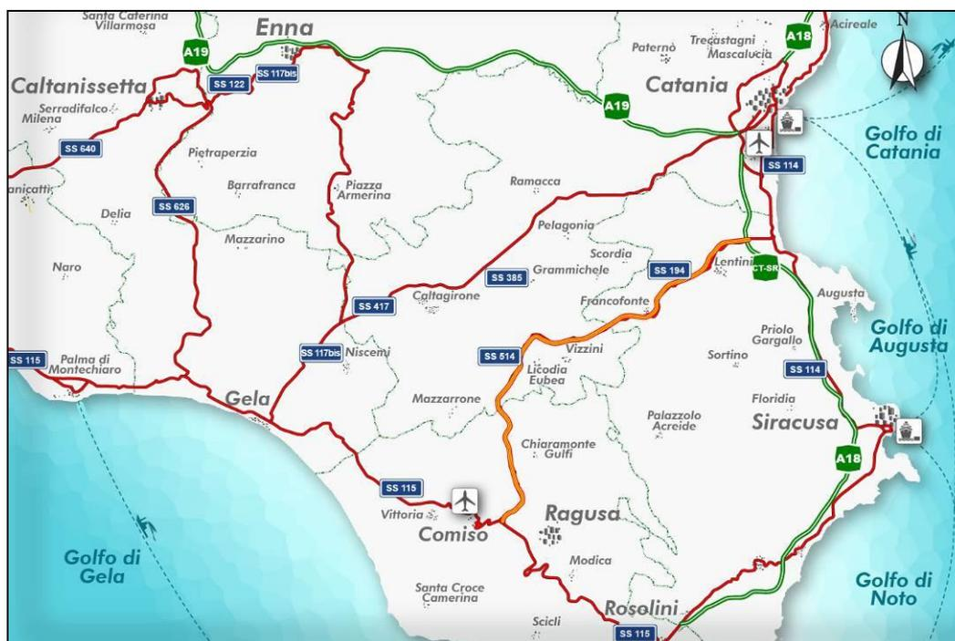
Il tracciato si snoda in larga parte sull'attuale sede delle SS524 e SS194, discostandosene solo nei tratti in cui l'adeguamento risulta impossibile per la presenza di parametri geometrici non compatibili con le norme progettuali di riferimento. Sono presenti due varianti significative
