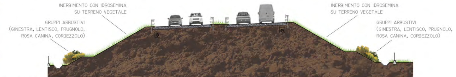
3. SEZIONE TRASVERSALE IN CORRISPONDENZA DI TRATTO IN RILEVATO ALTO DI TIPO BERNA - SISTEMAZIONE A VERDE DEL RILEVATO
