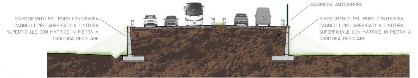
I. SEZIONE TRASVERSALE IN CORRISPONDENZA DI TRATTO IN RILEVATO TRA PARATIE CONTRORIPA IN AMBITO PERIURBANO
