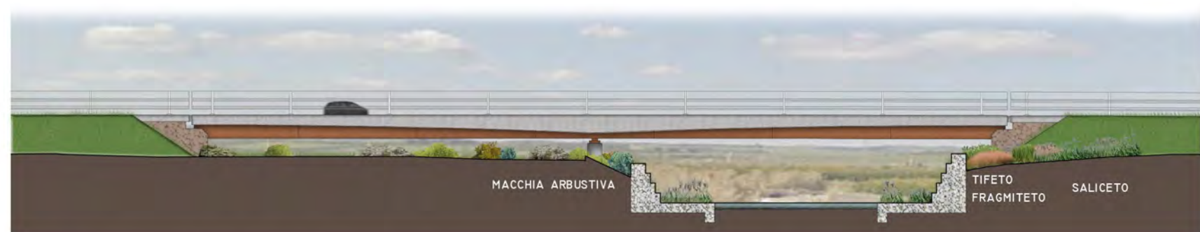
3. PROFILO LONGITUDINALE DEL VIADOTTO BARBAIANNI - INDICAZIONE DEGLI INTERVENTI DI ALLESTIMENTO DELLA RETE ECOLOGICA PRIMARIA
