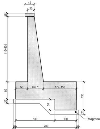
**SEZIONE TIPO MURO DA 2.01÷3.00**
