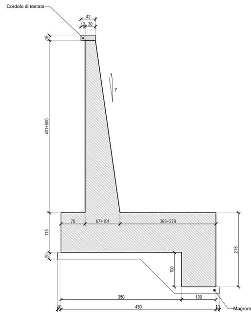
**SEZIONE TIPO MURO DA 4.01÷5.00**
