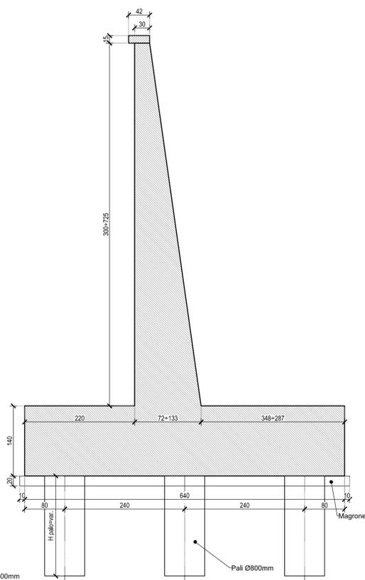
**SEZIONE TIPO MURO DA 2.00÷4.00**
