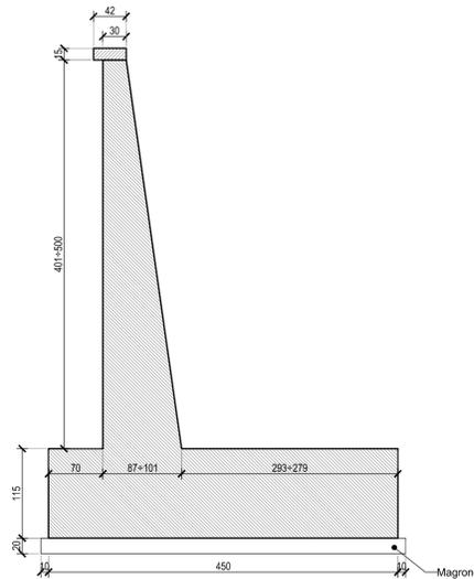
**SEZIONE TIPO MURO DA 4.01+5.00**
