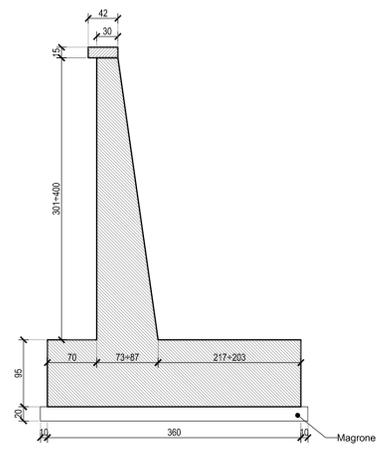
**SEZIONE TIPO MURO DA 3.01+4.00**
