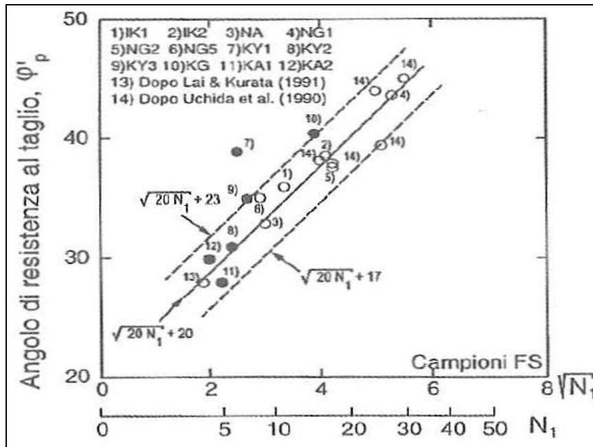
Il metodo è valido per sabbie fini o limose e trova le sue condizioni ottimali di applicabilità per profondità di prova superiori a 8-10 m per terreni sopra falda e superiori a 15.0 m per terreni in falda.
