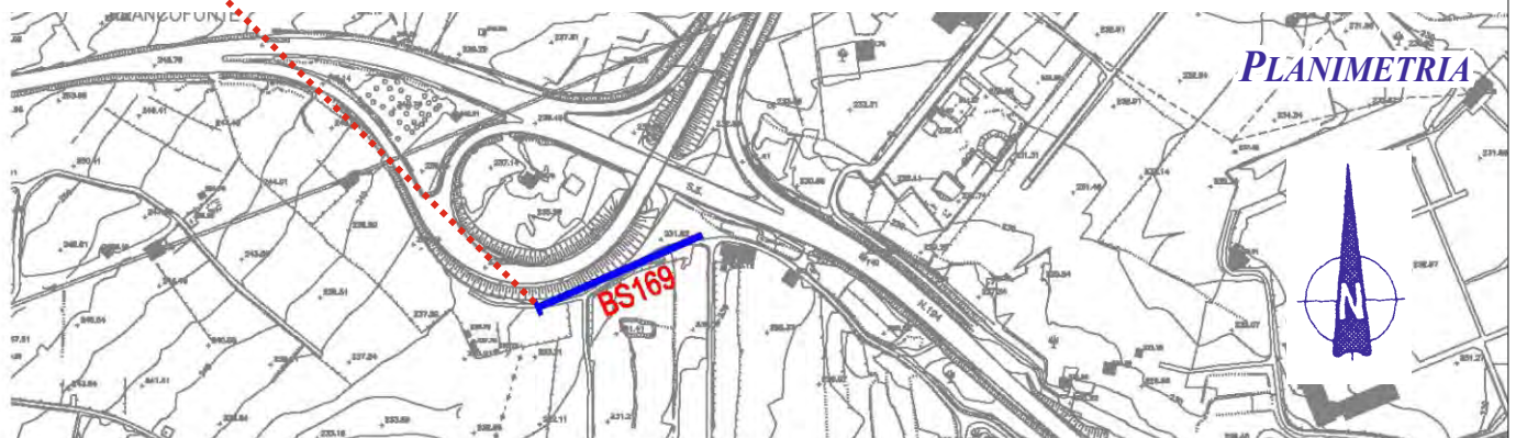
Geometria stendimento geofonico da 115 ml
