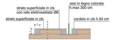
DETTAGLIO SEZIONE A-A scala 1:200
