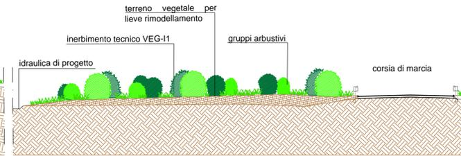
SCHEMA SEZIONE A'-A' scala 1:200
