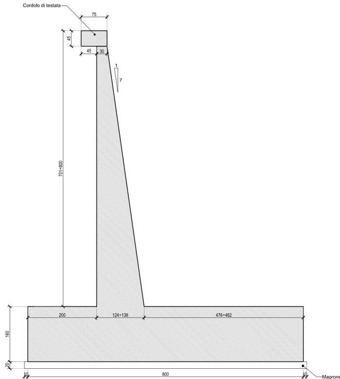
**SEZIONE TIPO MURO DA 7.01+8.00**
