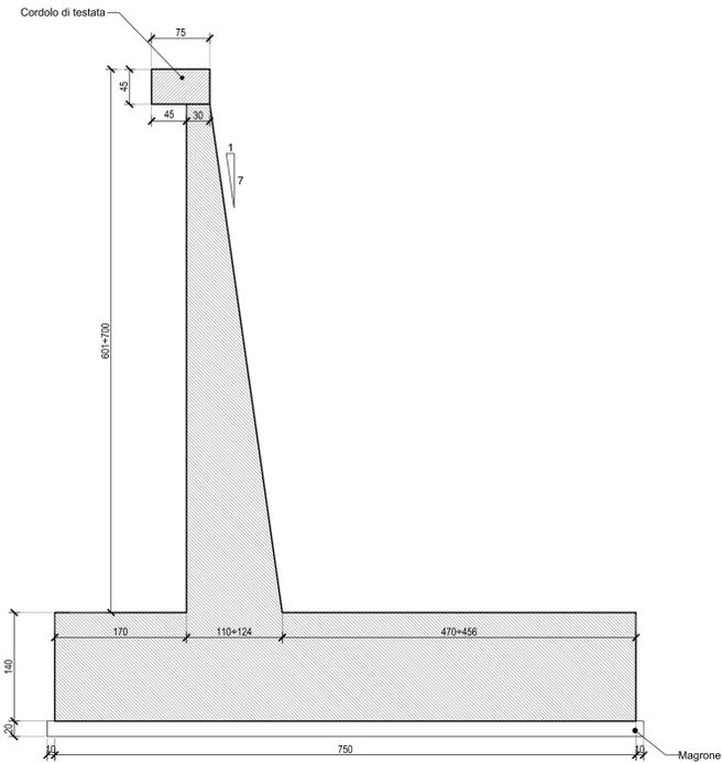
**SEZIONE TIPO MURO DA 6.01+7.00**
