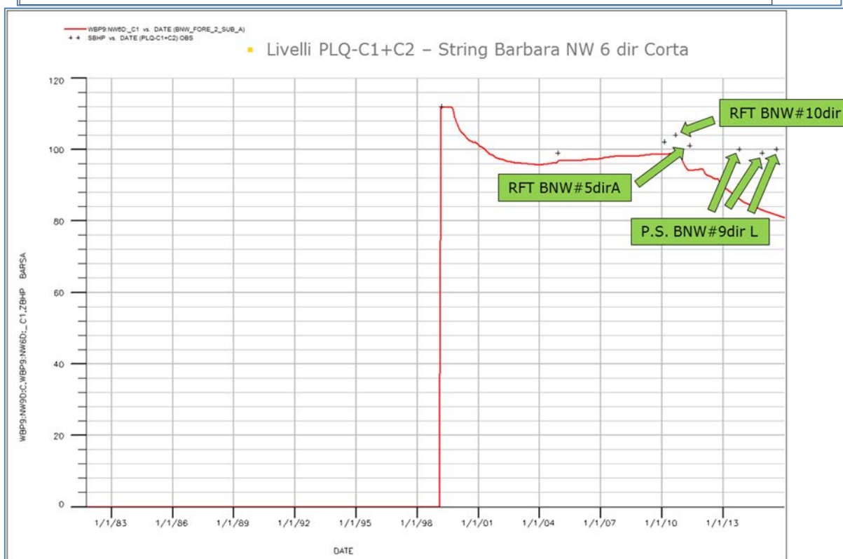
Figura 5 – Campo di Barbara NW: confronto tra i dati di pressione misurati e modello Eclipse (livelli PLQ-B+C1e PLQ-C1+C2)
