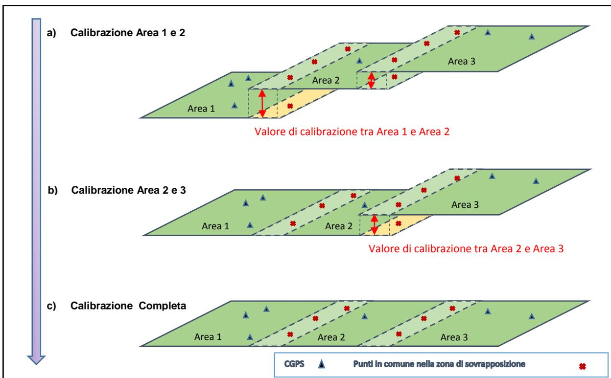
Fig. 2A – Schema illustrativo del processo di calibrazione delle immagini SAR con misure CGPS.
