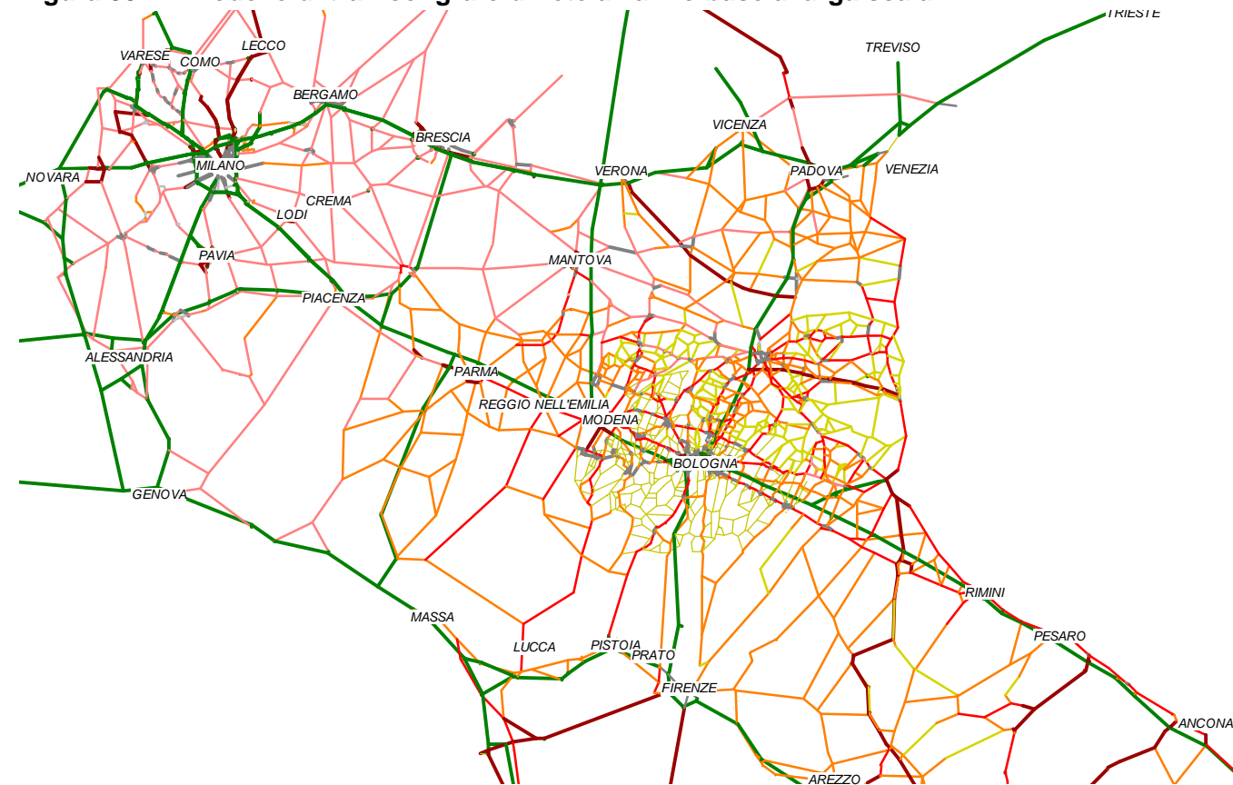
Figura 58 Modello di traffico: grafo di rete all'anno base a larga scala
