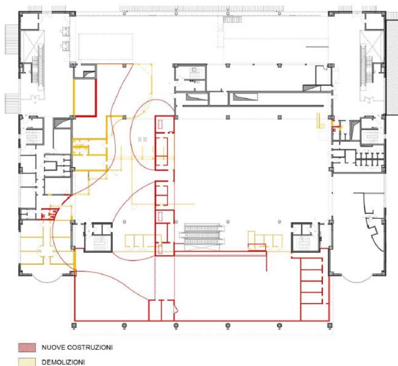
Fig. 99 - Pianta comparativa del primo piano – demolizioni/costruzioni
