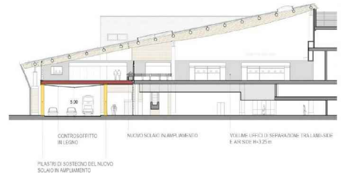
Sezione trasversale dell'aerostazione con evidenziati gli interventi
