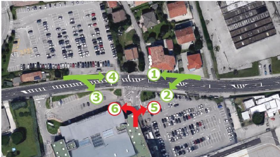
Figura 3-46: Intersezione attuale ingresso Aeroporto/Via Noalese – manovre di svolta censite (\*in rosso le manovre di svolta vietate ma rilevate)
