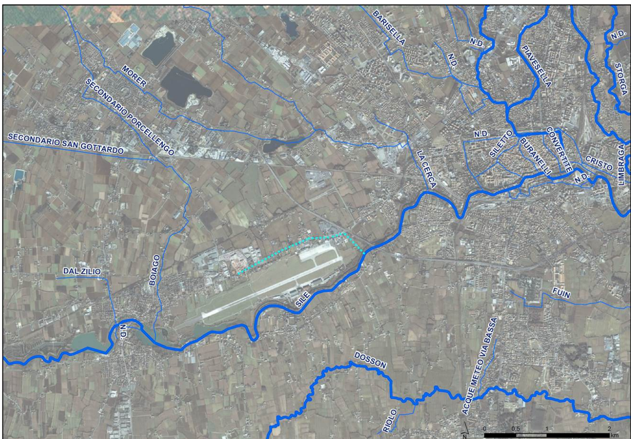
Figura C5-1 Idrografia superficiale nell'area prossima all'aeroporto di Treviso. La linea azzurra tratteggiata indica il fosso di guardia della via Noalese.
